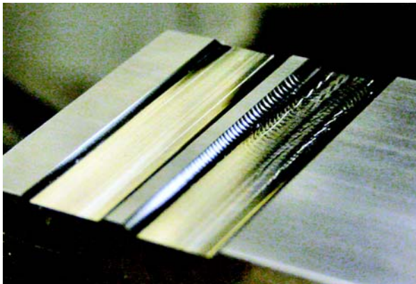
Rysunek 1: Dwie obróbki pokazujące warunki obróbki stabilnej i z drganiami.
