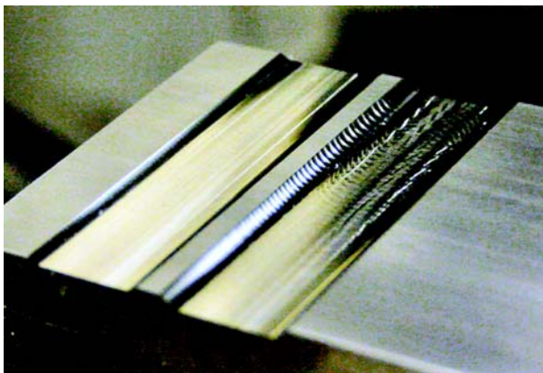
Rysunek 1: Dwie obróbki pokazujące warunki obróbki stabilnej i z drganiami.
